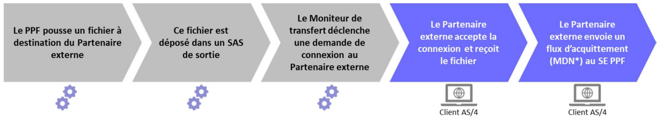
Figure 50 : Schéma d'un circuit retour d'un transfert par protocole AS/4
