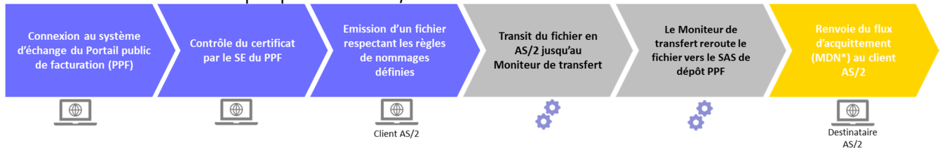
Figure 47 : Schéma d'un circuit aller d'un transfert par protocole AS/2
