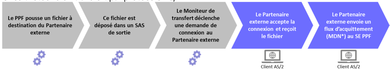
Figure 48 : Schéma d'un circuit retour d'un transfert par protocole AS/2
